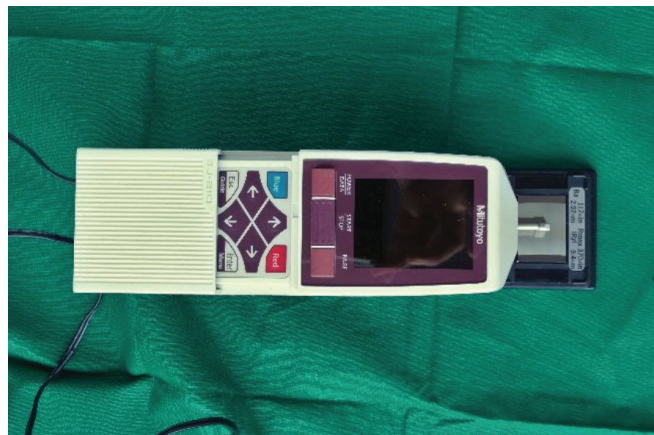
Fig. 2: Mitutoyo 178-561-02A SurfTest SJ-210 surface profilometer
